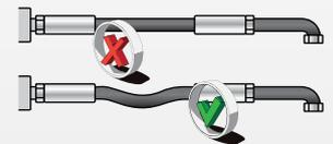
Deixe a linha da mangueira solta o suficiente para as mudanças de comprimento que ocorrerão quando a pressão for aplicada.
