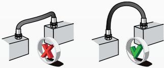
Para evitar o colapso e a restrição do fluxo, conserve o raio de curvatura o maior possível. Consulte as tabelas de especificações para obter o raio mínimo da curvatura.
